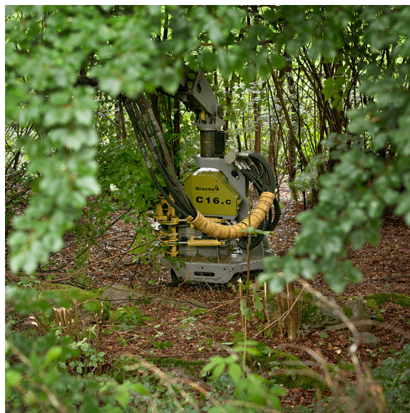
Bracke C16.c, ackumulerande fällaggregat för bioenergi och skogsvård.
