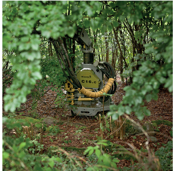
Bracke C16.c é um cabeçote acumulador para uso em biomassa e manejo florestal.
