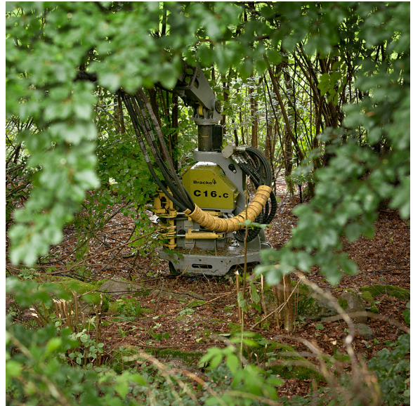
Bracke C16.c, kerävä hakkuukoura metsänhoitotöihin ja energiapuun korjuuseen.
