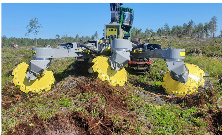
Bracke S35.a kan monteras på en-, två- och tre-radiga markberedningsaggregat.
