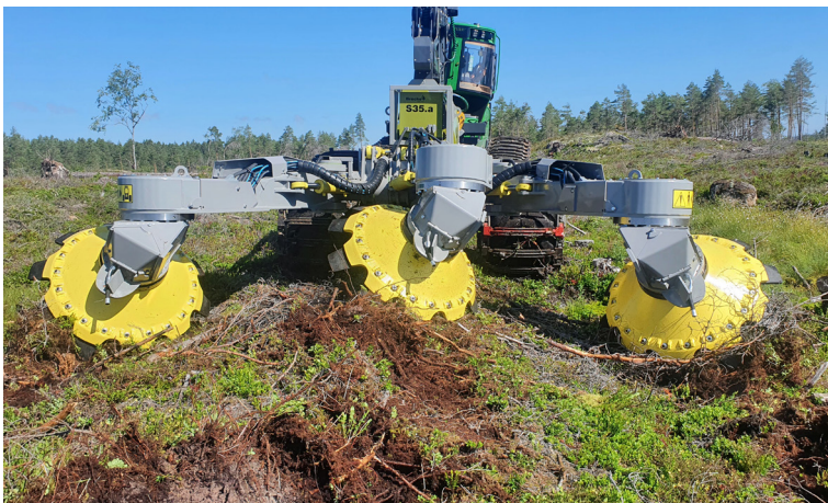
Das Säggregat Bracke S35.a kann auf ein-, zwei- und dreizeiligen Bodenvorbereitungsaggregaten montiert werden.
