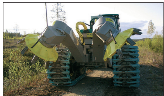
Bracke S35.a peut être monté sur une tête de conditionnement du sol à une, deux ou trois rangées.
